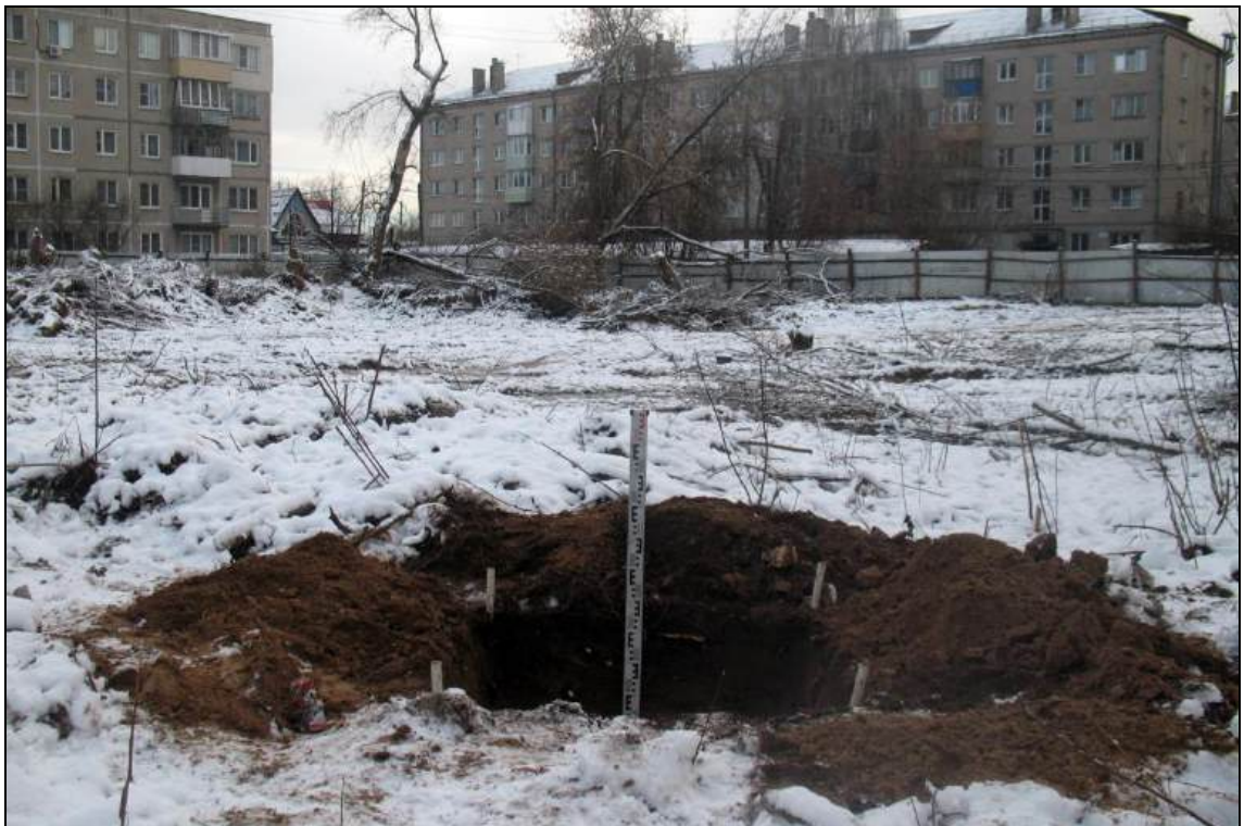
Илл. 12. Г. Бор. Земельный участок на ул. Воровского. Шурф после зачистки. Общий вид с запада.
